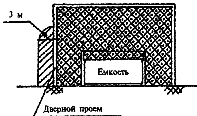
Рис. 1. Открытые емкости, аппараты, устройства в помещении
